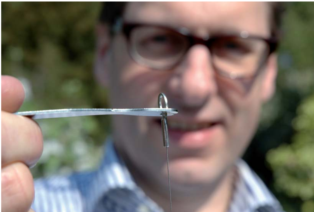
Jac Rongen toont hoe de draad gespannen blijft. De draad die het hart vormt van de reactiekamer waar niet alleen geur, maar ook stof wordt weggevangen.
